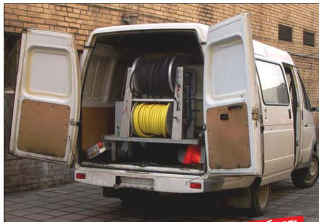
Пользователь может самостоятельно выбрать автомобиль типа "Газель", ЗИЛ "БЫЧОК" или прицеп, в который будет установлено устройство для прочистки труб водой под высоким давлением ROJET.
