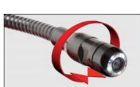
Самоцентрирующаяся головка камеры
